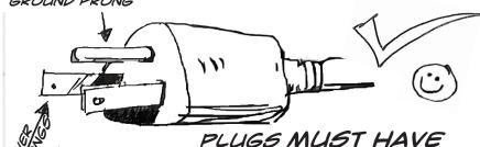
ALL PRONGS MUST BE IN GOOD CONDITION ALL OF THEIR PRONGS ESPECIALLY THE GROUND PRONG ("3RD" PRONG)
